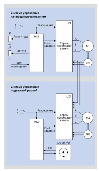
Рис.2. Функциональная схема стенда "Сервопривод и системы стабилизации"
